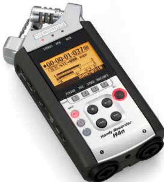
Questo recorder dal peso di 280 gr. registra su scheda SD ed è dotato di due microfoni a condensatore stereo di alta qualità in configurazione X/Y con angolo di ripresa a 90° o 120° oltre che due ingressi XLR con alimentazione phantom<sup>3</sup>.
